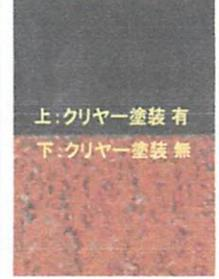
素地調整後、直接1回塗装、7日間乾燥後塩水噴霧試験(3時間)
